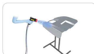
Ionisierung von Plastikteilen mit Luftpistole
