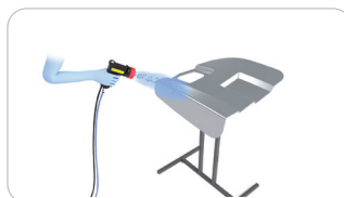
Ionisierung von Plastikteilen mit Luftpistole
