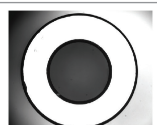
Kantenfehlererkennung, Fasenerkennung bei kleine Metallteilen
